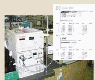
丸薬の製造に平行してバリデーションと呼ばれる品質確保の科学的検証と、日常工程の管理、質量偏差、含量均一性等の試験が行われる。2度目の選別が終わり出来上がった丸薬は、中間試験が待ち受けている。ここでは薄層クロマトグラフによる成分の確認試験、高速液体クロマトグラフによる定量試験を行う。医薬品として決まった成分が規定量含まれているかの試験。
