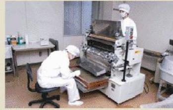
混合された粉末にエキス剤などの液体が加えられ、練合を繰り返し製丸機にかける。製丸中は常に水分量、形状、重量を注意し、また、重量にいたっては機械にくるいがないか5分に1度、計量器で測定する徹底ぶり。丸剤の製丸工程はとてもデリケートで細心の注意が必要となる。
