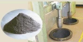
スライスされた鹿茸を強力な粉碎機、スタンプミルで粉砕する。粉砕したものを取り出し、手作業でトウシにかけ、少しの風でも吹き飛ぶような細かい粉末と、荒いものに分けられ、荒いものは再度機械にかけられる。より細かな粉末を作るため、手作業であるほかなく、又、一度に少量ずつしか粉末にできないため地道な作業を必要とする。
