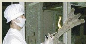
入荷した鹿茸には5mm~10mm程の幼毛がびっしり。成光ではそれらを専用バーナーを使い鹿茸の品質を変えないように細心の注意を払って焼き取っていく。凹凸が多く密集した幼毛を焼くのは容易ではなく、かなりの熟練を要する。鹿茸は次に粉末にしやすいよう、専用カッターで5mm~10mm幅にスライスされる。
